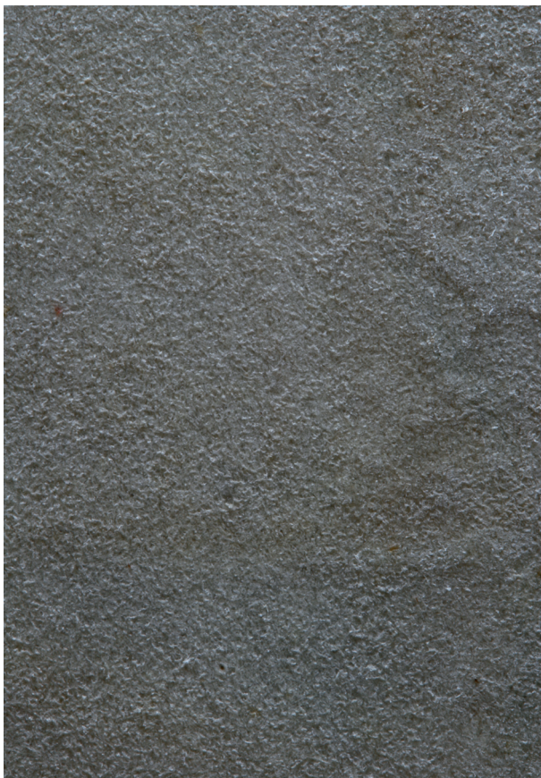
in Arbeit, Spiegel hinten: Der Pergamentflor ist komprimiert, die Oberfläche nicht mehr porös (siehe Kommentar).
