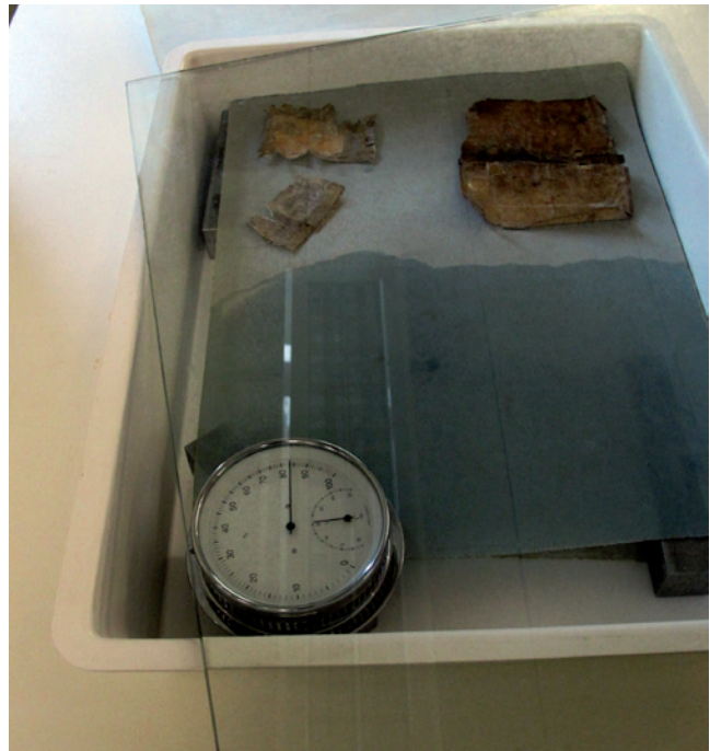
Klimakammer: Schale mit Feuchtigkeitsspender, Hygrometer und Glasdeckel
