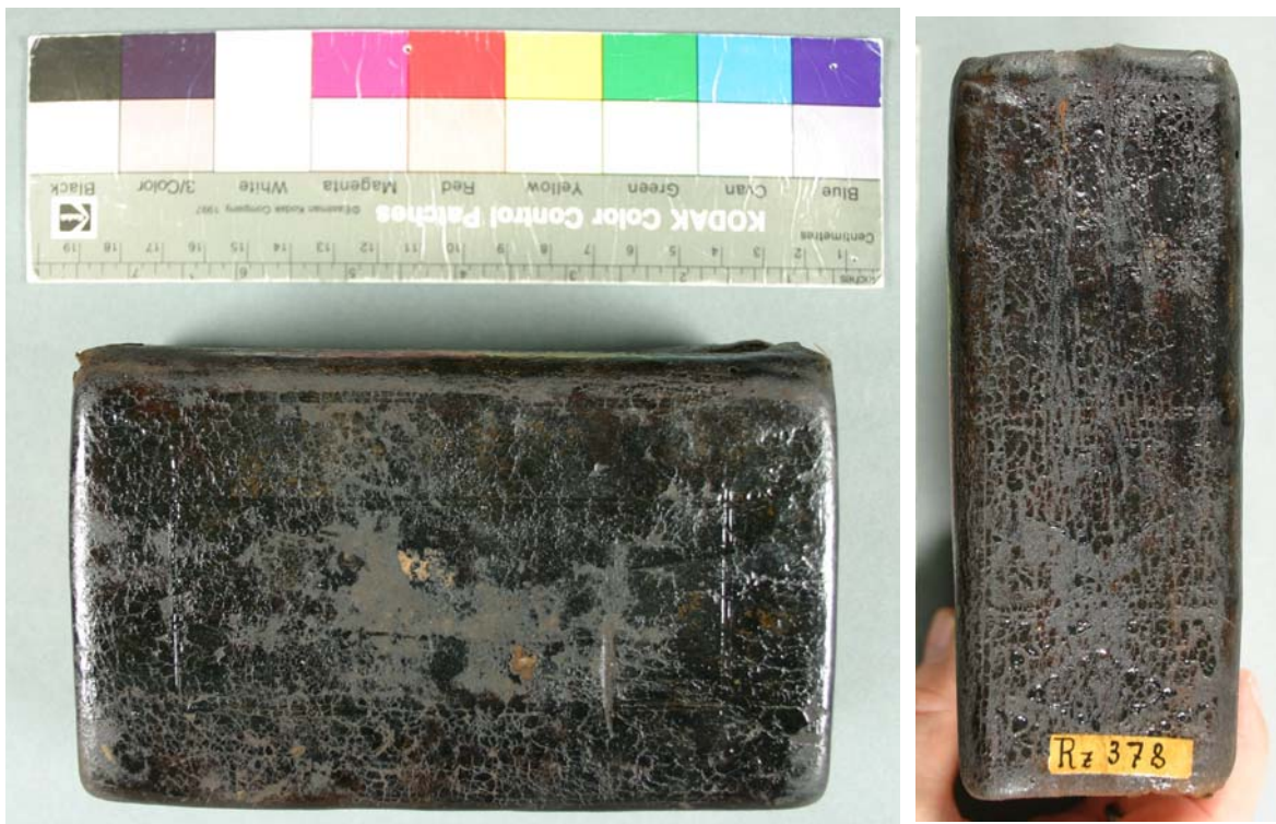
Abb.1: Vorderdeckel und Rücken eines schwarzen, vermutlich überfetteten Ledereinbandes aus dem Bestand; gut sichtbar ist die glänzende, klebrige Oberfläche, die inzwischen craqueliert ist und in kleinen Schollen vorliegt
