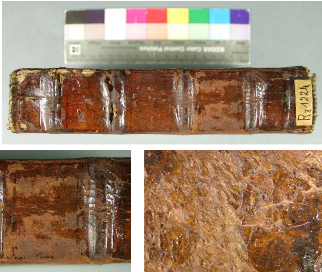
Abb.2: oben: Rücken des vermutlich überfetteten Ledereinbandes „Summa summarum“ aus dem Bestand; unten links: zweites Rückenfeld von unten, das bereits deutlichen Substanzverlust der Narbenschicht durch Abplatzen der Schollen zeigt ( Bildbreite ca. 5,2 cm); unten rechts: abgeplatzte Narbenschicht im zweiten Rückenfeld von unten (Bildbreite 1,1 cm)
