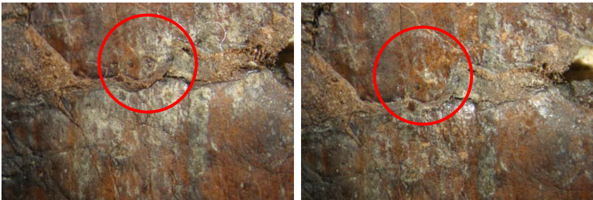
Abb. 17: links: Ausblühungen vor der partiellen Abnahme mit einem Skalpell unter dem Stereoskop; rechts: deutliche Reduktion der wachsartigen Beschichtungskomponente (beide Bildbreiten ca. 11 mm)
