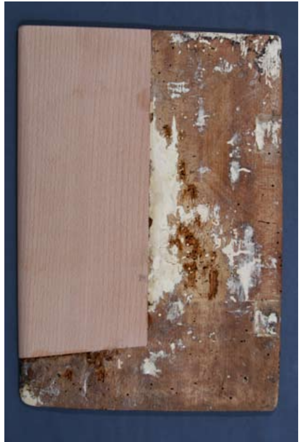
in Arbeit: vorderer Holzdeckel (aussen) ergänzt mit neuem Buchenholz und Kittmasse aus Bärlappsporen
