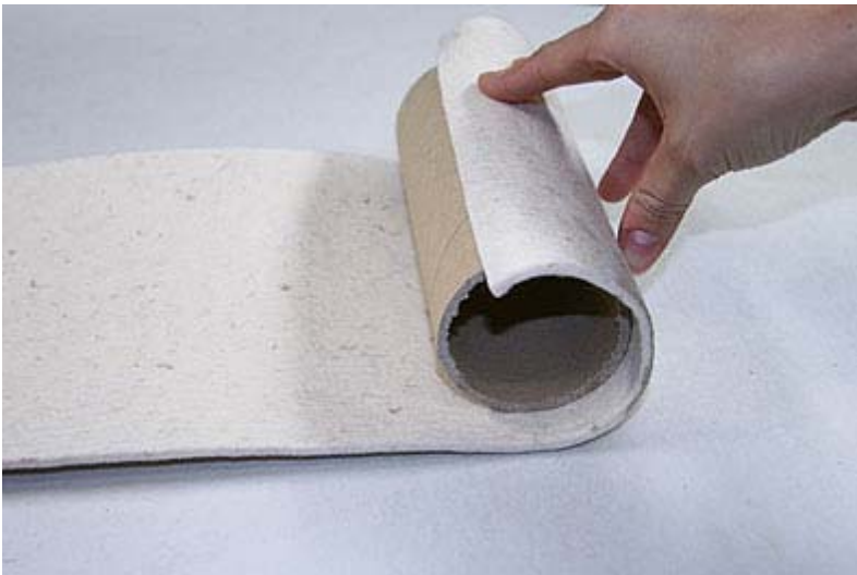
Le bout de feutre est enroulé autour du tube en carton des deux côtés.
