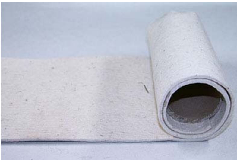
Stade avancé du bout de feutre enroulé autour du tube en carton.
