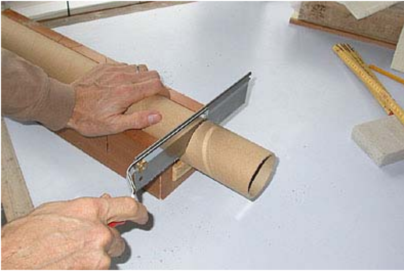
Le tube en carton est découpé à l'aide d'une scie.
