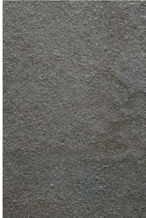
Abb. 3 Die Struktur des Pergamentes nach dem Ablösen mit GoreTex.
